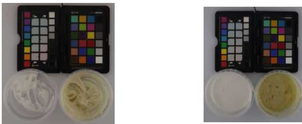
Í upphafi geymslu við 40°C Eftir geymslu við 40°C í 2 daga. Mynd 34. Myndir af prófunum á stöðugleika ýrulausna. Kremgrunnur til vinstri og krem með extrakti (1%) af laufblöðum og stilkum rósa. Colorchecker passport (X-rite) var notað sem litaviðmiðun.
